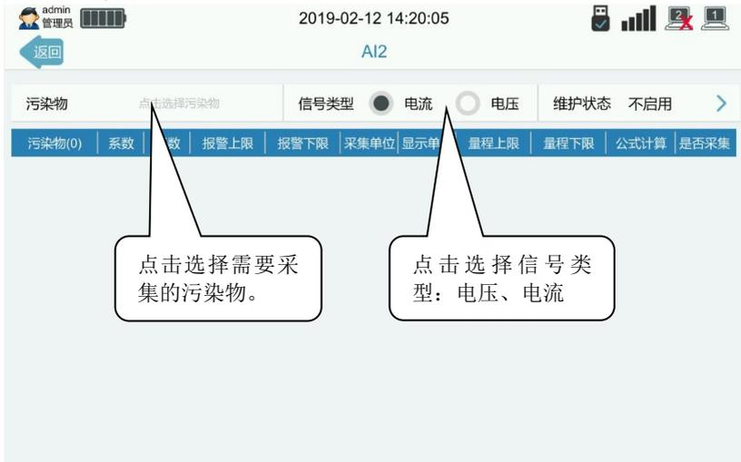
图 1.3.1 模拟量参数设置界面
