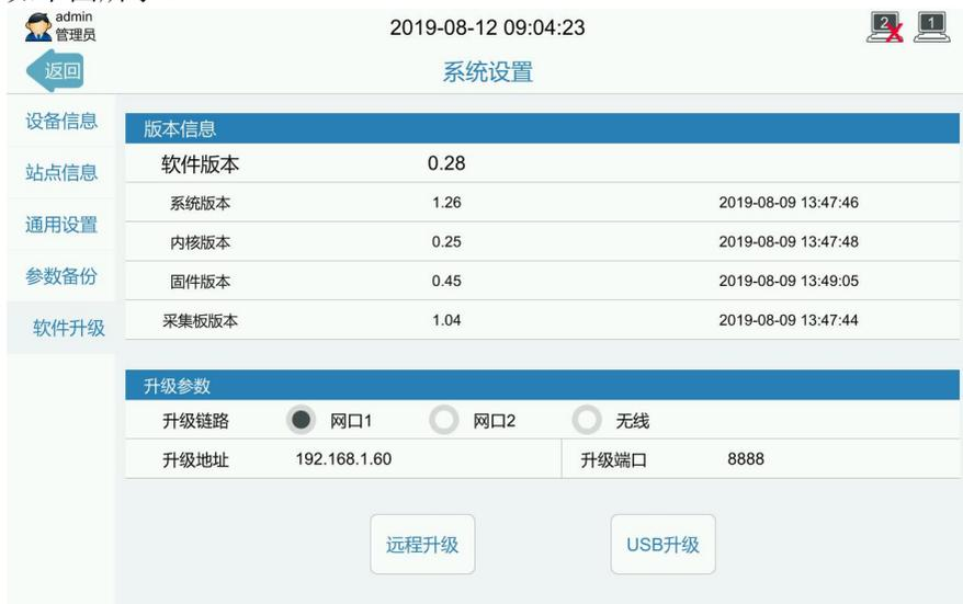
第四步，点击远程升级，系统将提示警告：确定使用远程升级方式更新系统？点击确定，系统将进入自动升级界面，如下图所示。
